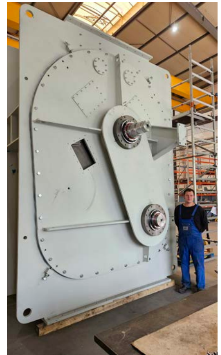
Bild 1: Eintragungsschleuse für Zementmühle
